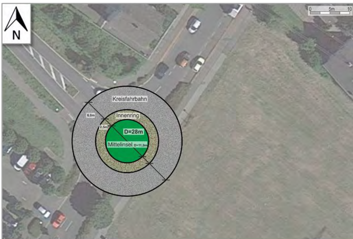
Abbildung 62: Systemskizze In den Höhen / Krankenhausstraße
